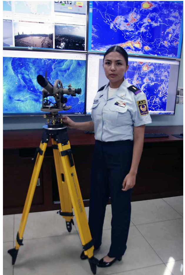
La Subteniente Hernández no muestra un teodolito, que junto con un globo piloto se usan al aire libre para el cálculo de viento en la vertical, lo utilizan con inflado de Helio, se deja libre y después se sigue su trayectoria con un teodolito, registrándose periódicamente su posición (azimut y elevación), su peso estándar es de 120 gramos, cuentan con diversos colores: blancos, rojos y negros, el color ayuda para que sea más fácil su visibilidad, están hechos de caucho, están fabricados para que resistan la temperatura a grades alturas.
