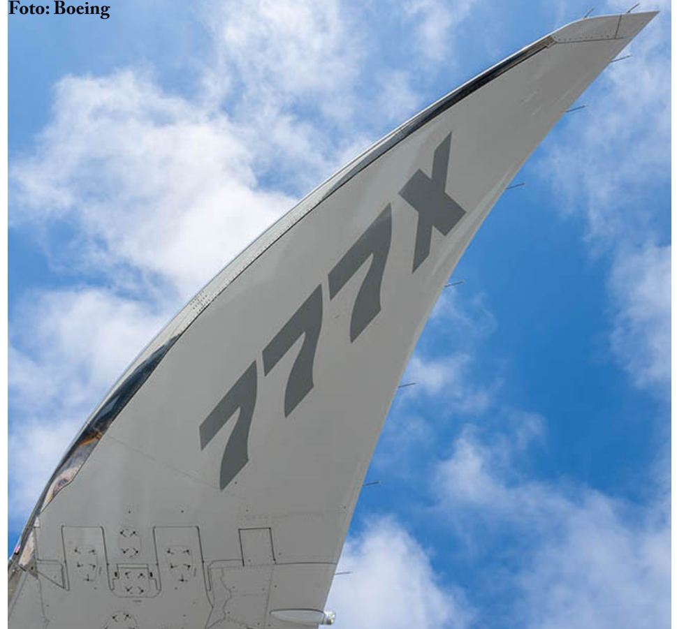
Detalle del ala. Un tipo similar de ala plegable se ofreció también en el Boeing 777 para optimizar el espacio en los aeropuertos, pero ninguna aerolínea lo solicitó. Foto: Boeing
