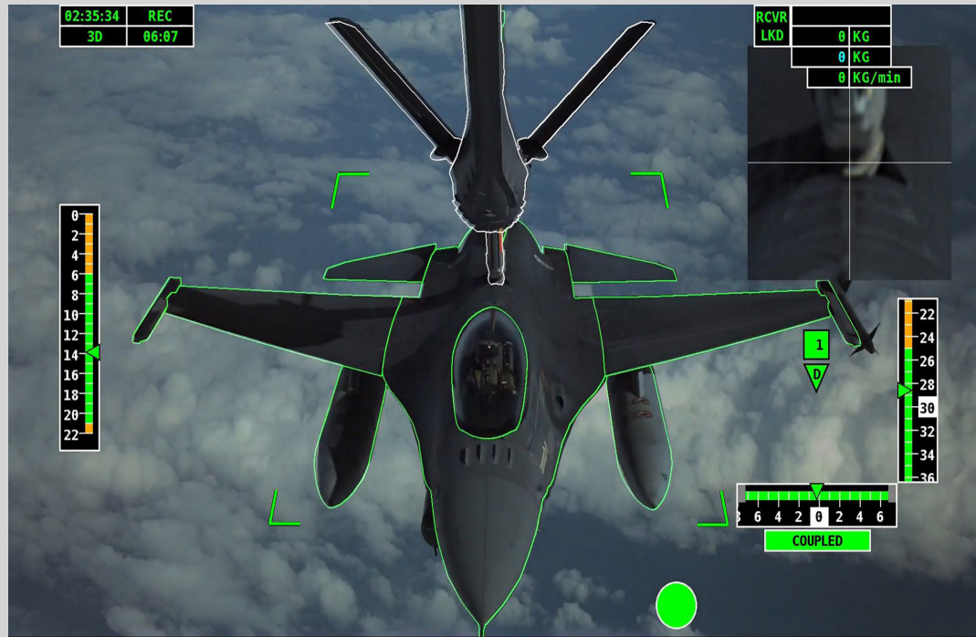
La imagen muestra los primeros contactos de reabastecimiento de combustible totalmente automatizados entre un avión de prueba de un avión cisterna Airbus y un avión de combate F-16 de la Fuerza Aérea portuguesa.. Imagen Airbus
