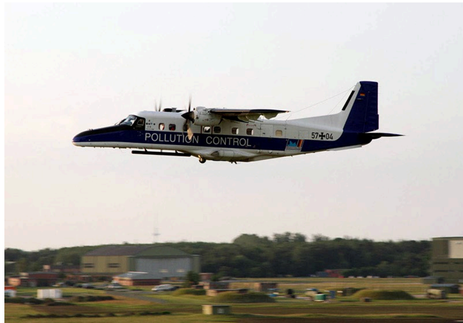
Un DO 228 LM despegando desde su base de operaciones en Nordholz. La antena de su sistema de radar es claramente visible debajo del fuselaje. ©Bundeswehr/Bilal Bektas
